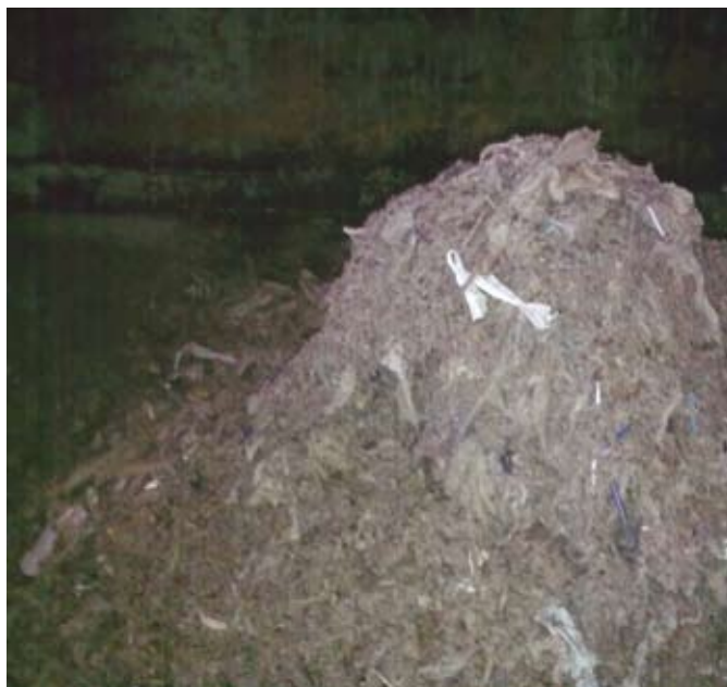
Chusteczki spowodowały awarię w oczyszczalni Zdjęcie: Wodociągi Kieleckie
